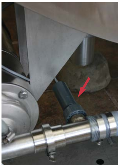
Ce sont les sondes qui envoient l'information au thermographe.
